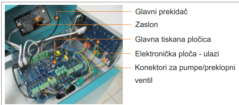
Slika 5. Konektori za priključenje napajanja, el. dijelova i osjetnika
