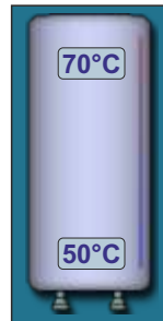
Akumulacijski spremnik s prikazom gornje i donje temperature
